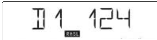
Exemple 1 : dropout N° 1 après 124 secondes.
