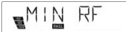
Exemple 2 : niveau HF minimum de -90 dB.
