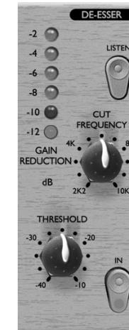
**IN (Schalter)** – Schaltet den DE-ESSER in den Signalweg. Wenn er eingeschaltet ist, leuchtet die rote LED im Schalter.
