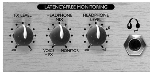
**FX LEVEL (potentiomètre)** - Ce potentiomètre contrôle le niveau de l'entrée de retour d'effet FX RETURN située en face arrière. Par exemple, la réverbération peut être appliquée par un processeur externe en utilisant les connecteurs (mono) FX SEND et (stéréo) FX RETURN, de sorte que le chanteur peut entendre sa voix avec la réverbération lors de l'enregistrement.
