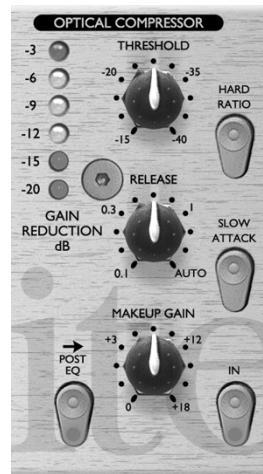
**MAKEUP GAIN (potentiomètre)** – Détermine le niveau en sortie de l'étage de compression. En effet, la compression atténue le niveau global du signal : utilisez le réglage MAKEUP GAIN pour obtenir le même niveau après qu'avant compression. Comparez le volume du signal avant et après compression à l'aide de la touche IN.
