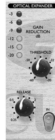
**GAIN REDUCTION (LED meter)** – Mostra quanta riduzione di guadagno è stata applicata, ed i LEDs dovrebbero illuminarsi progressivamente durante i passaggi a basso livello. Durante i passaggi a livello più alto invece, i LEDs dovrebbero spegnersi. Osservando i meter durante un passaggio vocale, potete controllare che l'Expander Ottico non stia agendo sulla voce: se i meters rimangono illuminati durante il passaggio vocale, abbassate il controllo di THRESHOLD.
