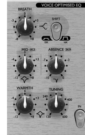
**MID (potentiomètre)** – Accentue ou atténue les hauts médiums de la voix. Ce circuit utilise un filtre en cloche centré sur 1,3 kHz.
