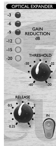
**IN (Schalter)** – Schaltet den OPTICAL EXPANDER in den Signalweg. Wenn er eingeschaltet ist, leuchtet die rote LED im Schalter.
