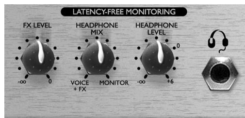
**FX LEVEL (control)** - Controla el nivel de la entrada FX RETURN de la trasera. Por ejemplo, se puede aplicar reverberación desde un procesador externo mediante los conectores FX SEND (mono) y FX RETURN (estéreo), para que el vocalista escuche su voz con el proceso aplicado cuando se graba.
