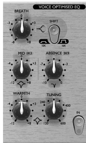
**IN (Schalter)** – Schaltet den VOICE OPTIMISED EQ in den Signalweg. Wenn er eingeschaltet ist, leuchtet die rote LED im Schalter.
