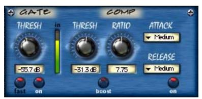
Figure 124. The Gate/Comp module
