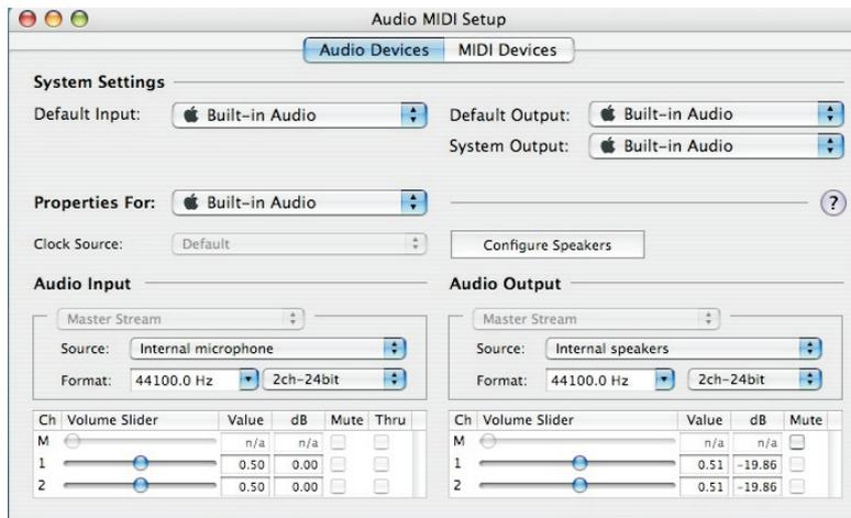
Entra a la sección de Dispositivos de Audio (Audio Devices). Desde la pestaña "Properties for", selecciona FireFly 302. Al final de la ventana, los usuarios pueden editar la configuración de la interfase FireFly 302 . Las propiedades como frecuencia de muestreo y reloj, pueden ser alteradas.
