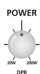
DPRコントロールは出力を200W(100%)から20W(10%)までのいずれかのポジションにセットできます。音量の数字上の変化量と聴感上の変化量はその性質上一致しません。
