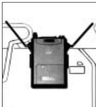
Fig. 9: Orientation des antennes
