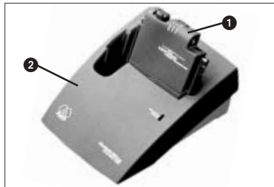
Dib. 4: Recargar las pilas recargables con la estación de carga opcional CU 40
