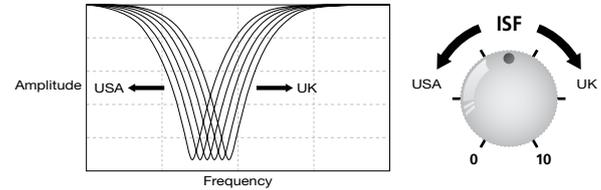
Wir empfehlen Ihnen, den ISF-Regler mittig und die Klangregelung nach Wunsch einzustellen. Anschließend drehen Sie den ISF-Regler gegen oder im Uhrzeigersinn, bis Sie den gewünschten Sound gefunden haben.
