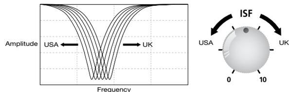
Nous vous recommandons de commencer avec le réglage d'ISF positionné au centre et la commande de tonalité à votre goût. Essayez ensuite d'ajuster progressivement l'ISF jusqu'à trouver le son désiré.
