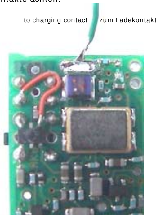
A: roter Draht zu Ladekontakt über Diodekathode im Batteriehalter B: grüner Draht zu Anschluß 3 des XLR Steckers C: roter Draht zu Anschluß 2 des XLR Steckers
