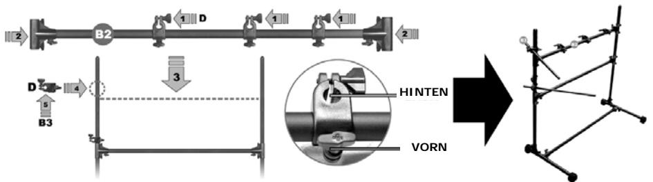
4. Schieben Sie drei Klemmen (D) auf die Querstange (B2) und zwei horizontale Klemmen (C) auf die beiden Enden. Schieben Sie diese Konstruktion, wie gezeigt, auf die zwei senkrechten Stangen. Schieben Sie nun eine weitere Klemme (D) auf die linke senkrechte Stange, diese wird für das Pedalbecken verwendet. Schieben Sie dann eine kleine Stange (B3), wie gezeigt, in die Klemme (D).
