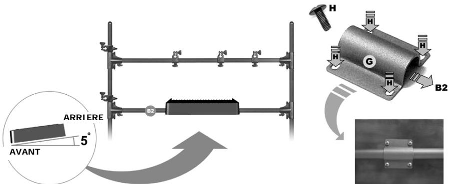
7. Fixez le support de montage (G) à l'arrière du module de déclenchement (Trigger Box) iET01 tel qu'illustré. Fixez à la barre horizontale inférieure et formez un angle de 5° tel qu'indiqué dans l'illustration. La boîte à rythmes iDM01 doit reposer sur ce module.
