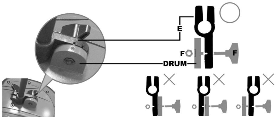
6. Montieren Sie die fünf Teile (A3) an jede der fünf Schlagflächen. Bringen Sie den Bolzen und die Mutter (F) wie gezeigt an.
