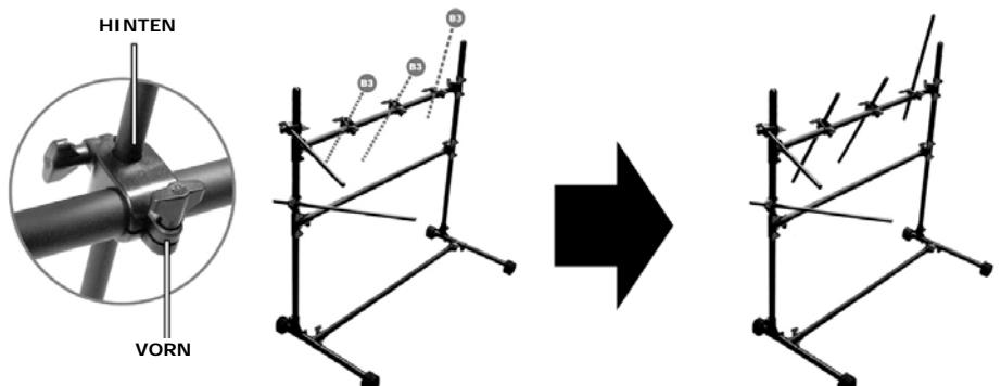
5. Schieben Sie drei kleine Stangen (B3) in die verbleibenden Klemmen (C) entlang der oberen Querstange.
