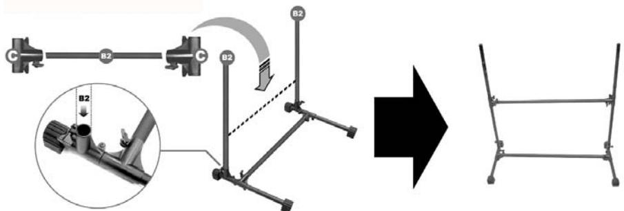
11. Inserire due barre verticali (B2) negli alloggiamenti rimanenti rivolti verso l'alto come illustrato. Inserire due morsetti (C) ai capi di una barra orizzontale (B2). Far scorrere sulle due barre verticali come illustrato.
