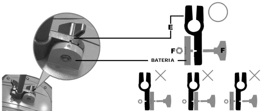
6. Fije las cinco partes (A3) a cada uno de los cinco pads de la batería. Fije el perno y la tuerca (F) como se muestra.
