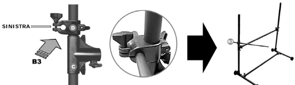
12. Far scorrere un morsetto (D) lungo la barra verticale sinistra, che verrà impiegata per il rullante. Far scorrere una barra piccola (B3) nel morsetto (D) come illustrato in figura.
