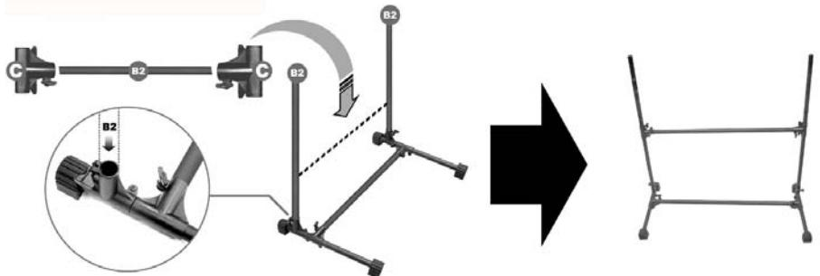
2. Schieben Sie die zwei senkrechten Stangen (B2) in die verbleibenden Aussparungen, wie in der Abbildung gezeigt, nach oben gerichtet ein. Schieben Sie zwei Klemmen (C) auf die Enden der Querstange (B2). Schieben Sie diese dann, wie gezeigt, auf die zwei senkrechten Stangen.
