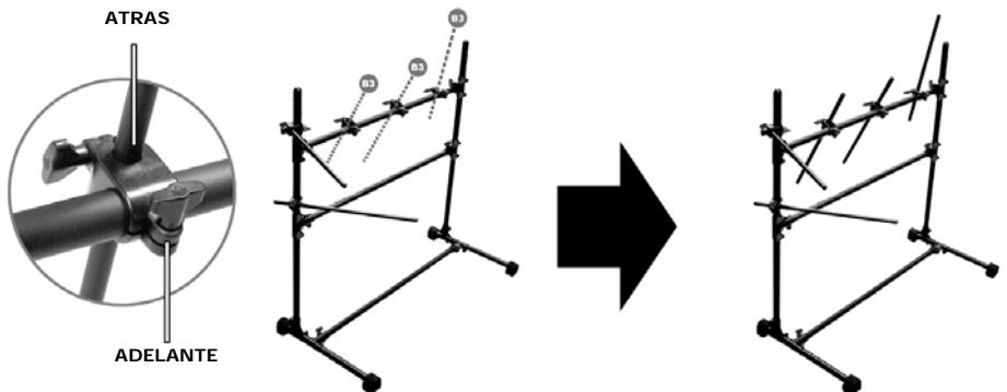
5. Inserte las tres barras pequeñas (B3) en las abrazaderas de fijación (C) restantes en la barra horizontal superior.
