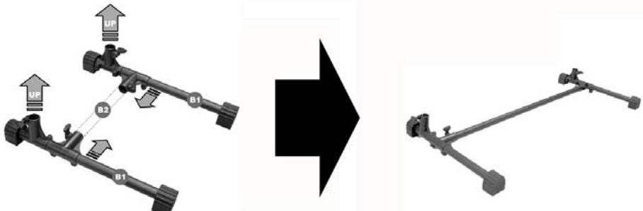
10. Inserire i piedini in gomma (A1) ai capi di ciascuna barra alla base del supporto (B1). La parte piatta della gomma è rivolta al suolo. Installare una barra orizzontale (B2) sul morsetto orizzontale predisposto (C) come da illustrazione.
