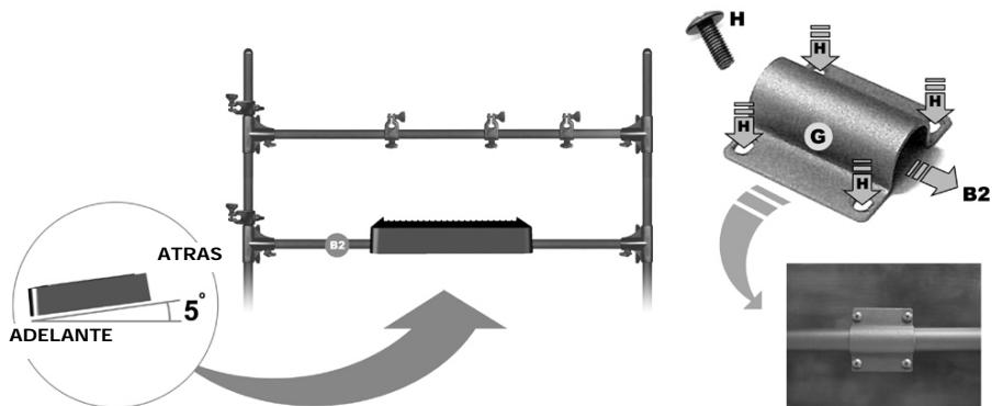
7. Fije la mediacaña de montaje (G) a la parte posterior de la caja de disparo del iET01 como se muestra en la figura. Fíjela a la barra horizontal inferior como se muestra en la figura e inclínela adecuadamente. La máquina de ritmos iDM01 se colocará sobre esto.
