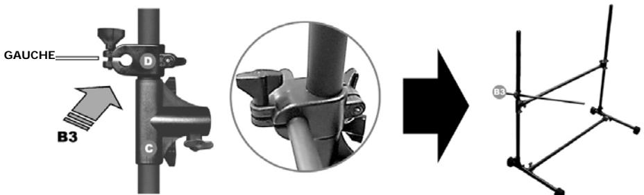
3. Faites glisser une bague de fixation (D) le long de la barre verticale gauche qui servira pour le pad de la caisse claire. Faites glisser une petite barre (B3) dans la bague (D), tel qu'illustré.
