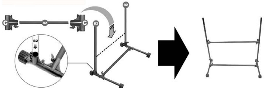
2. Insérez deux barres verticales (B2) dans l'emplacement prévu sur les fixations, tel qu'indiqué. Insérez deux bagues à angle droit (C) aux extrémités d'une barre horizontale (B2). Insérez et faites glisser les bagues sur les deux barres verticales, tel qu'illustré.
