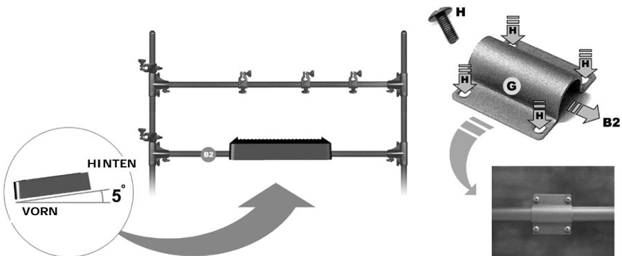
7. Bringen Sie die Halteklammer (G) an der Rückseite der iETO1-Trigger Box wie in der Abbildung gezeigt an. Montieren Sie diese an die untere Querstange wie in der Abbildung gezeigt und richten Sie diese im angegebenen Winkel ein. Sie dient als Basis für den IDM01 Schlagzeugcomputer.
