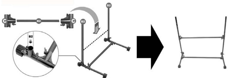
2. Inserte dos barras verticales (B2) en las ranuras restantes hacia arriba, como se muestra en la figura. Introduzca dos abrazaderas de fijación (C) en los extremos de una barra horizontal (B2). Deslice las dos barras verticales como se muestra en la figura.
