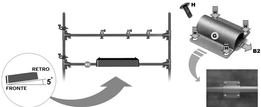
16. Attaccare il supporto di montaggio (G) alla parte posteriore dell'iET01 Trigger Box come illustrato in figura. Attaccarlo alla barra orizzontale inferiore come illustrato in figura ed angolare di conseguenza. La Drum Machine IDM01 verrà a trovarsi su di esso.
