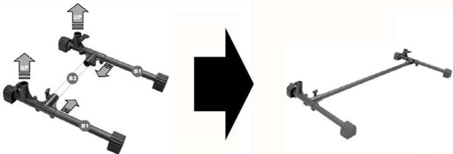
1. Befestigen Sie die Gummifüße (A1) an den Enden jeder Basisstange (B1), mit dem flachen Teil des Fußes zum Boden hin. Befestigen Sie die Querstange (B2) an der bereits installierten horizontalen Klemme (C), wie in der Abbildung gezeigt.
