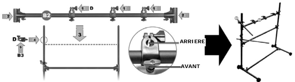
4. Insérez trois bagues de fixation (D) sur une barre horizontale (B2) et fixez deux bagues à angle droit (C) aux extrémités. Faites glisser l'assemblage sur les deux barres verticales, tel qu'illustré. Faites glisser ensuite une autre bague de fixation (D) le long de la barre verticale gauche qui servira pour le pad de charleston. Faites glisser ensuite une petite barre (B3) dans la bague de fixation (D), tel qu'illustiqué.
