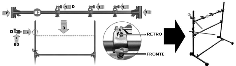
13. Inserire tre morsetti (D) su di una barra orizzontale (B2) ed inserire due morsetti orizzontali (C) alla fine. Far scorrere l'insieme sulle due barre verticali come illustrato. Far scorrere ora un altro morsetto (D) lungo la barra verticale sinistra, che verrà impiegato per l'Hi-Hat. Quindi far scorrere una barra piccola (B3) nel morsetto (D) come illustrato.
