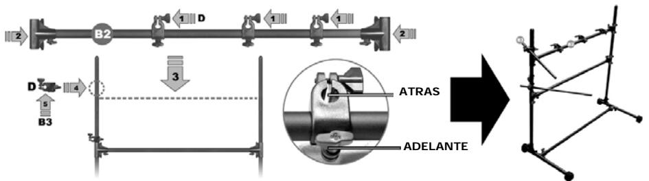
4. Inserte tres abrazaderas de fijación (D) en una barra horizontal (B2) y coloque dos abrazaderas horizontales (C) en el extremo. Deslice las dos barras verticales como se muestra en la figura. Ahora deslice otra abrazadera de fijación (D) hacia debajo de la barra vertical izquierda que será usada para el Hi-Hat. Luego, deslice una barra pequeña (B3) en la abrazadera de fijación (D) como se muestra en la figura.
