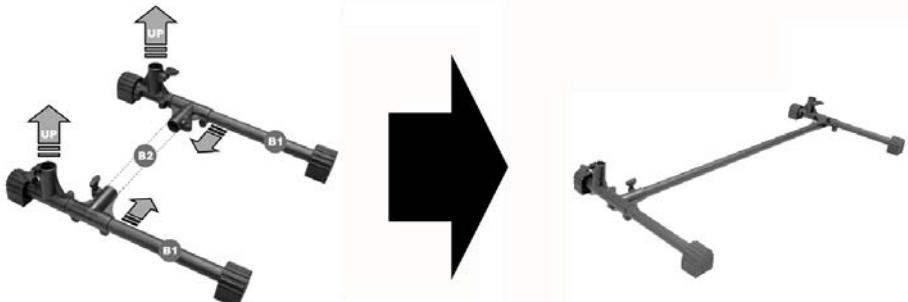
1. Fixez les pieds en caoutchouc (A1) sur l'extrémité des barres (B1) à la base du support. Le côté plat du pied en caoutchouc face au plancher. Fixez une barre horizontale (B2) dans la fixation horizontale préinstallée (C), tel qu'illustré.
