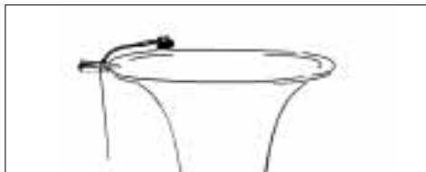
Fig. 5: Fissaggio del microfono sulla tuba
