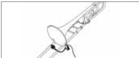
Fig. 6: Fissaggio del microfono sul trombone
