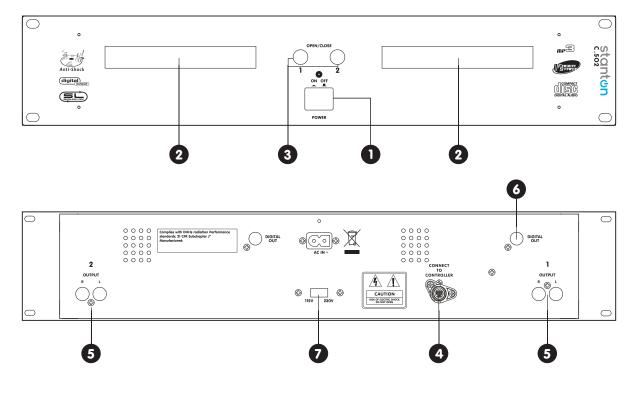
(1)POWER(2)DISC HOLDER(3)OPEN/CLOSE(4)REMOTE CONTROL CONNECTOR
