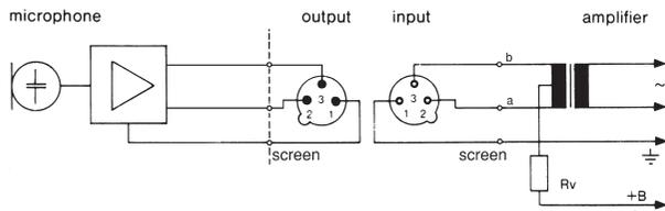
Conexión con transformador de entrada **sin** derivación central (aislado de tierra):
