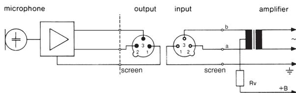
Collegamento con trasformatore d'ingresso **senza** presa mediana (senza terra):
