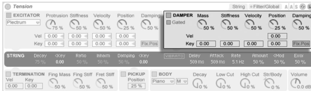
La sección Damper de Tension.
