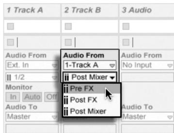
*Puntos de conexión para encaminamiento de pistas.*
