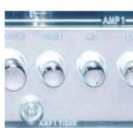
**TIGHT:** Bewirkt eine Absenkung „mulmiger“ Bassfrequenzen, wie sie bei Cleansounds auftreten können, wenn die Wiedergabe über eine 4x 12“ Box erfolgt. Durch die Frequenzanpassung bekommt der TriAmp® MK II das für Combos typische Wiedergabeverhalten.
