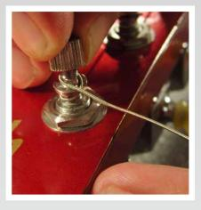
BEND THE STRING AROUND THE SHAFT AS SHOWN IN THE PICTURE AN SCREW ON THE LOCK NUT.
