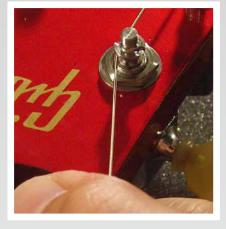
PULL TIGHT ON THE STRING TO GET PRETENSION AND BEND IT ONE HALF TURN AROUND THE BOTTOM SIDE OF THE STRING SHAFT.
