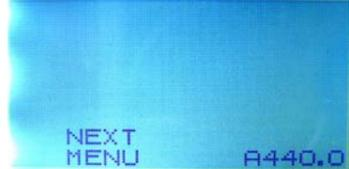
Para modificar el valor A=440.0Hz del tono de concierto, pulse el botón SELECT hasta que se muestre el valor que desee. El StrobeStomp puede calibrarse de A=433Hz hasta A=447Hz en incrementos de 0.5Hz. (NOTA: Para salir de cualquiera de los menús EDIT, desconecte el afinador antes de ir a la página "SAVE" y se actualizarán los valores anteriores).
