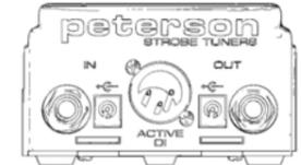
Para activar la DI, desconecte el afinador, levante la tapa del compartimento de la batería y retire la batería. Con el dedo índice, BAJE los dos interruptores basculantes. Conecte un cable XLR blindado a la salida DI activa y al dispositivo que vaya a conectar (consola PA/grabación). El StrobeStomp se suministra con la DI activada.
