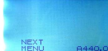
Pour ajuster le diapason à une valeur différente de A(la)=440Hz, appuyez sur le bouton SELECT jusqu'à ce que la valeur désirée s'affiche. Le StrobeStomp peut être calibré de A(la)=433Hz à A(la)=447Hz par intervalles de 0,5Hz.
