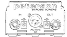
Pour activer le système DI, débranchez l'accordeur et retirez le couvercle du compartiment de la pile ainsi que la pile. En utilisant votre index, placez les deux commutateurs DIP en position DOWN (bas). Branchez un câble XLR blindé entre la sortie DI actif et l'appareil à brancher (console d'enregistrement/mixage). Le StrobeStomp est livré avec le système DI activé.
