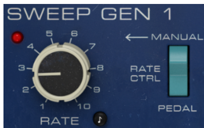
El interruptor que activa el controlador de pedal en la sección del generador de barrido 1
