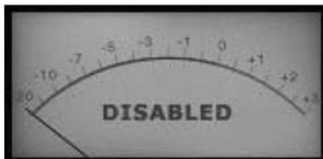
**Figura 2:** El 24/7-C aparecerá con "las luces apagadas" y el mensaje disabled aparecerá en la pantalla del medidor VU.
