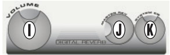
**I. MASTER VOLUME LEVEL CONTROL** - P80の出力ボリュームを調節します。マスター・コントロールは、ノッチがございます。ほとんどの用途においては、ノッチのある真上（12時）の設定で良好なバランスが得られます。より高い音量が必要な場合は、センター・ポジションより右側に回すことにより、さらに6dBのゲインが得られます。
