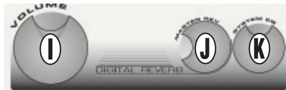
**I. CONTROLLO MASTER VOLUME LEVEL** – Il controllo Master Volume regola il volume in uscita di P80. Il sistema Passport è stato bilanciato per la maggior parte delle applicazioni ad operare con questo controllo regolato nella sua posizione centrale. Nelle situazioni in cui si renda necessario utilizzare un livello maggiore di volume, il controllo Master è in grado di fornire ulteriori 6 dB di guadagno, ruotando la manopola in senso orario.
