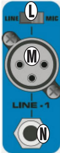
**M. CONECTOR MIC INPUT** – Conecte aquí su micrófono. Esta es una toma XLR de tres puntas balanceada hembra pensada para señales de entrada de micrófonos con baja impedancia.
