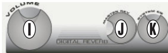
**I. MASTER VOLUME-PEGELREGLER** – Der Master Volume-Regler steuert den Ausgangspegel des P80. Der Master-Regler besitzt eine Einkerbung zur Positionsanzeige. Das Passport-System wurde so abgestimmt, dass dieser Regler bei den meisten Anwendungen auf 12 Uhr (Kerbe) eingestellt werden kann. In Situationen, in denen mehr Pegel benötigt wird, kann der Master-Regler durch eine Rechtsdrehung zusätzliche 6 dB Verstärkung erzeugen.
