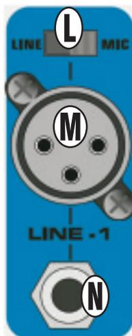
**M. マイク入力端子** - マイクを接続します。この3ピンXLRバランス入力端子はロー・インピーダンスのマイクを接続する様に設計されています。
