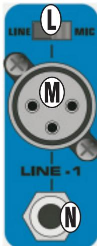
**M. MIC INPUT-BUCHSE** – Hier schließen Sie Ihr Mikrofon an. Diese 3-polige, symmetrische XLR-Eingangsbuchse ist für Signale von niederohmigen Mikrofonen ausgelegt.
