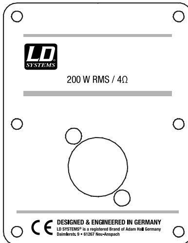
Los satélites del sistema LD DAVE18G3 tienen cada uno un conector compatible Speakon. Emplee un cable apropiado de 2 conductores (sección mín. de 2 x 1,5 mm<sup>2</sup>) para la conexión entre el subwoofer (SAT POWER OUT LEFT/RIGHT) y los satélites, con conectores compatibles Speakon. Configuración: 1+ / 1-).
