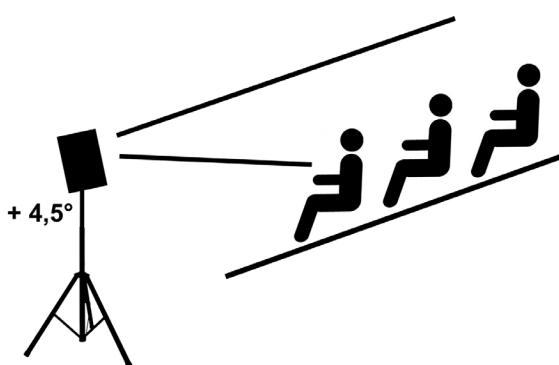
Um bei einer Tribünenbeschallung ein optimales Abstrahlverhalten zu erhalten, wählen Sie einen nach oben gerichteten Neigungswinkel.
