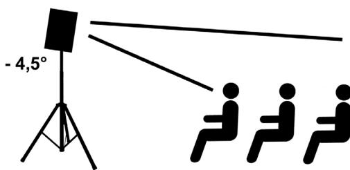
Si le public est assis dans la salle à sonoriser, et dans des salles de dimensions réduites, il est recommandé d'incliner davantage les enceintes vers le bas. On améliore ainsi la couverture acoustique en proximité, et on évite de plus les réflexions sonores gênantes sur le plafond et les murs arrière.
