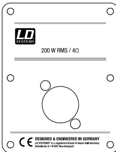
Ciascuno degli altoparlanti satelliti dell'impianto LD DAVE18G3 dispone di un collegamento altoparlante Speakon compatibile. Realizzare il collegamento tra subwoofer (SAT POWER OUT LEFT / RIGHT) e altoparlanti satelliti utilizzando un cavo idoneo (cavo per altoparlante a 2 fili, min. 2 x 1,5 mm<sup>2</sup>) con connettori Speakon compatibili. Configurazione: 1+/1-.
