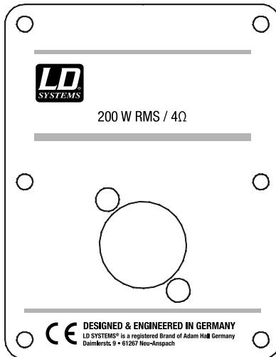
Les enceintes satellites du système de sonorisation LD DAVE18G3 s'alimentent par l'intermédiaire d'un connecteur compatible Speakon. Pour assurer la liaison entre les sorties HP du caisson de basses (repérées SAT POWER OUT LEFT / RIGHT) et les enceintes satellites, nous recommandons d'utiliser un câble "spécial haut-parleur", à deux conducteurs, d'une section minimale de  $2 \times 1,5 \text{ mm}^2$ , équipé de connecteurs compatibles Speakon . Câblage : 1+ / 1-).
