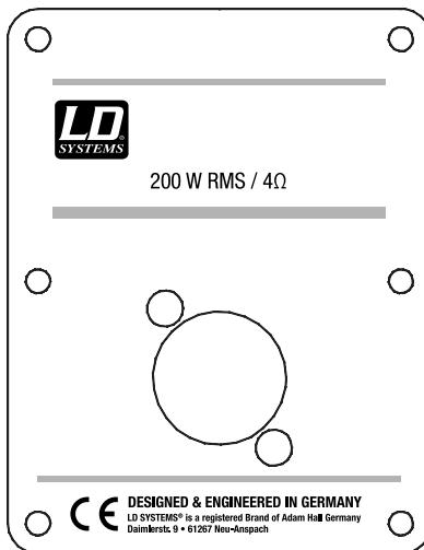
Die Satelliten-Lautsprecher der LD DAVE18G3 Anlage verfügen je über einen Speakon kompatiblen Lautsprecheranschluss. Stellen Sie die Verbindung zwischen Subwoofer (SAT POWER OUT LEFT / RIGHT) und Satelliten-Lautsprechern unter Verwendung eines geeigneten Kabels her (2-adriges Lautsprechkabel, min. 2 x 1,5 mm<sup>2</sup>, mit Speakon kompatiblen Steckern. Belegung: 1+ / 1-).
