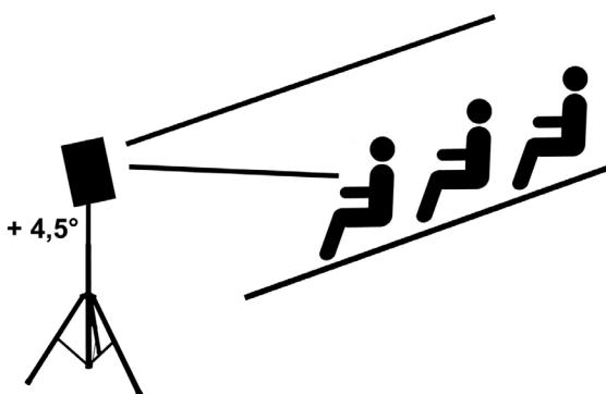
Aby zapewnić optymalną emisję dźwięku w pomieszczeniach z trybunami, należy wybrać ustawienie kąta nachylenia w górę.
