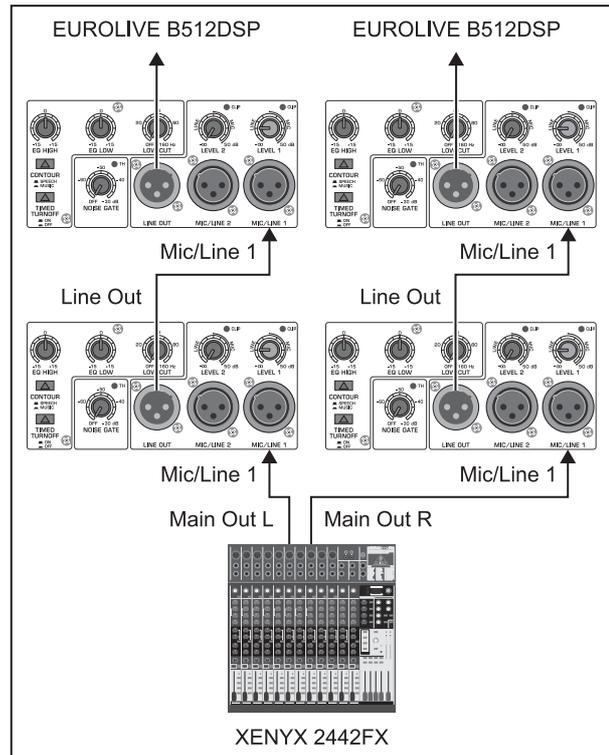
Fig. 3.3: Conexión en serie de varios B512DSP
