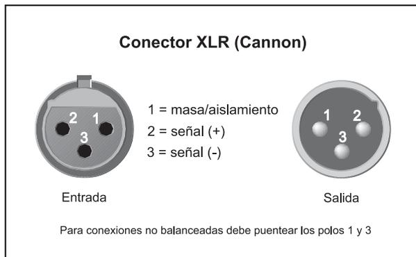
Fig. 4.1: Conexiones XLR
