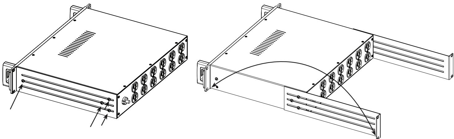
Simplemente quite los tornillos de seguridad de las porciones frontal y lateral de la muesca del estante posterior ajustable y la placa lateral de refuerzo (ubicados en cualquiera de los laterales del chasis). Inviértalos y vuelva a adjuntarlos al chasis del P-2400 AR. (como se muestra a la derecha).
