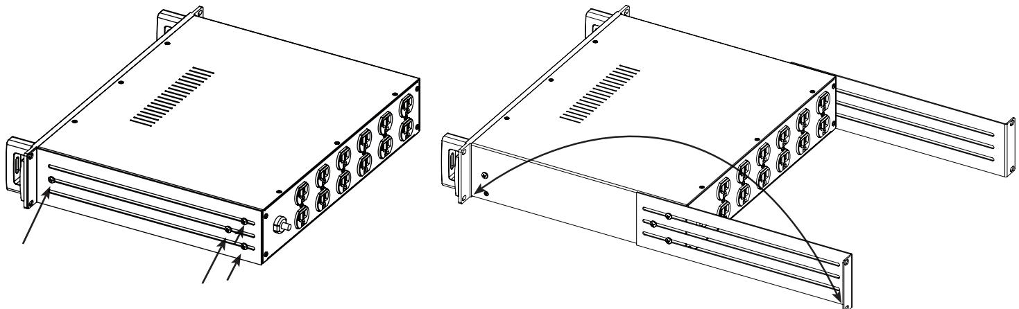
Retirez simplement les vis de montage des parties avant et latérales du bâti réglable à l'arrière du P-2400 AR et la plaque latérale de renfort (située d'un côté ou de l'autre du châssis). Inversez-la et réassembliez-la sur le châssis du P-2400 AR (comme montré sur la droite).
