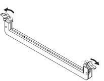
4. Prenez bien note de l'emplacement et de l'orientation de l'encoche du module de mémoire et insérez-le verticalement à l'intérieur des guides qui se trouvent de chaque côté de la prise.
