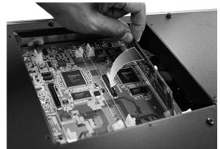
\* Ne jamais user de force excessive pour installer une carte de circuits imprimés. Si elle ne s'ajuste pas adéquatement au premier essai, la retirer et essayer à nouveau. 5. Appuyer fermement vers l'intérieur jusqu'à ce que les languettes soient bloquées dans les ouvertures de la carte d'expansion.
