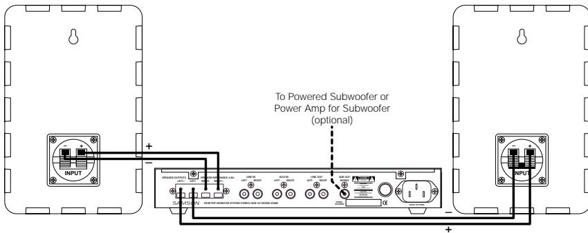
3. Connectez le SUBWOOFER (optionnel). Reliez le connecteur SUB OUT MONO à une enceinte subwoofer amplifiée ou à un amplificateur alimentant une enceinte subwoofer. Vous devez utiliser un câble blindé pour cette connexion car il s'agit d'une sortie de niveau ligne. Le potentiomètre SUB LEVEL détermine le niveau du Sub Woofer après le réglage de volume général. Ajustez le potentiomètre SUB LEVEL afin d'obtenir un bon équilibre entre le subwoofer et les haut-parleurs.
