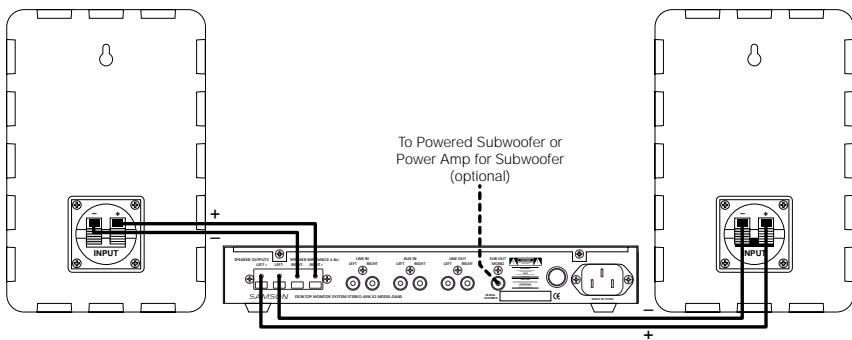
3. Conecte el SUBWOOFER (opcional). Conecte la toma SUB OUT MONO a un subwoofer auto-amplificado o a un amplificador que de señal a un altavoz subwoofer. Dado que esto es una salida de nivel de línea, deberá usar un cable blindado para esta conexión. El SUB LEVEL regula el volumen del subwoofer después del control MASTER VOLUME. Ajuste el control SUB LEVEL hasta que consiga una buena mezcla entre el subwoofer y los altavoces.
