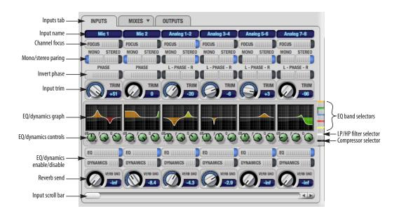
Figure 11-3: The Inputs tab.
